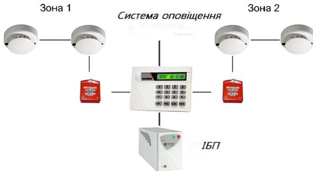
Рисунок 1.3 - Схема побудови типової ручної системи протипожежного захисту [32]
