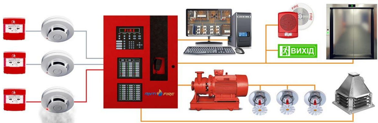
Рисунок 1.2 - Схема побудови типової автоматичної системи протипожежного захисту [25]
