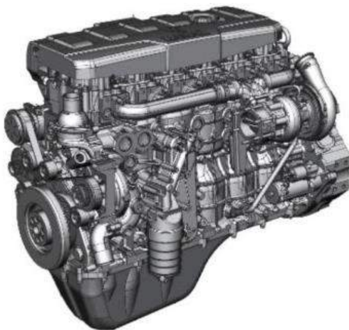
Рисунок 1.2 – Загальний вигляд двигуна КАМАЗ Р6 910.15-450 / Євро-5
