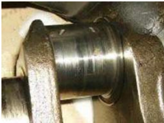
Рисунок 3.3 – Зношування шатунної шийки КВ
