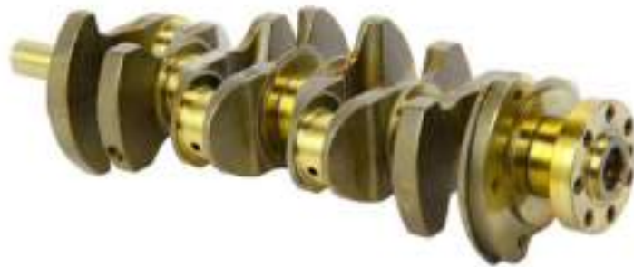
Рисунок 2.1 – Колінчастий вал Liebherr D904
