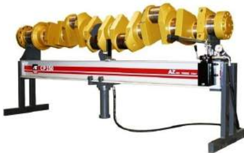
Рисунок 5.3 – Гідравлічний прес для виправлення КВ CP150-250 [36, 37]
