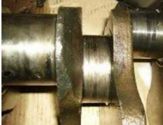
Рисунок 3.2 – Зношування корінної шийки КВ
