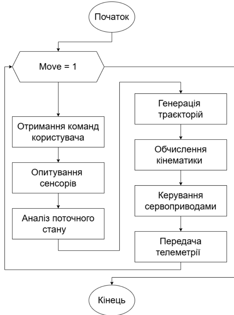
Рисунок 3.4 - Загальна схема циклу руху гексаподу
