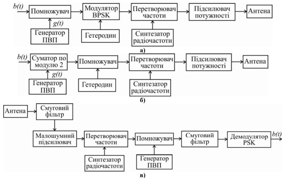
Рис. 5. Структурні схеми передавача і приймача сигналів з розширеним спектром: а) передавач; б) другий варіант побудови передавача; в) приймач
