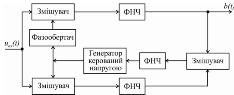
Рис. 7. Схема Костаса для демодуляції сигналів BPSK
