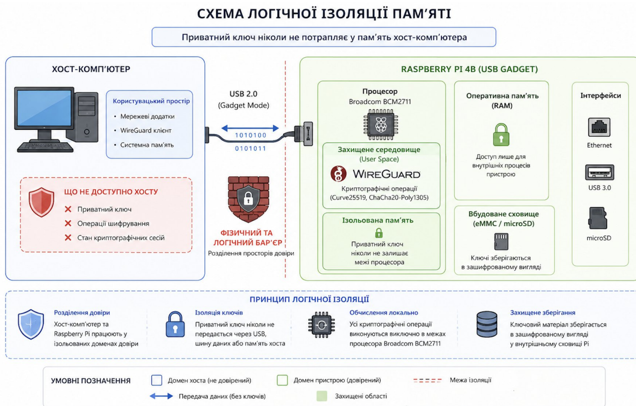
Рисунок 2.2 – Схема логічної ізоляції пам'яті
