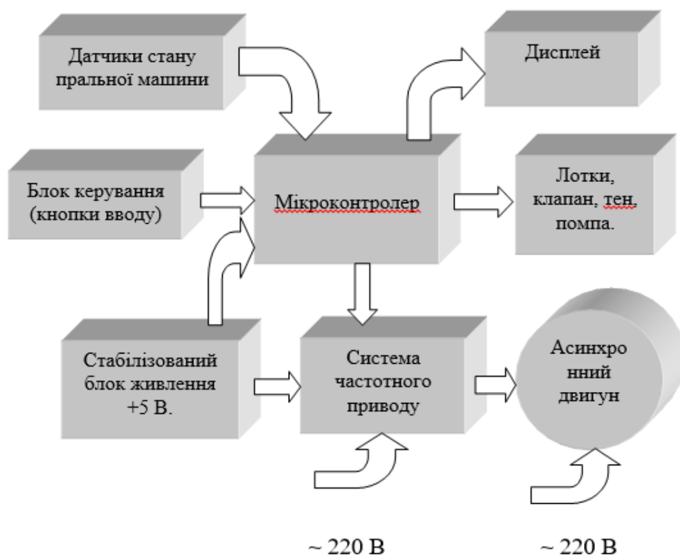
Рисунок 2.3 – Структурна схема керування пральною побутовою машиною з використанням мікроконтролера та частотного приводу
