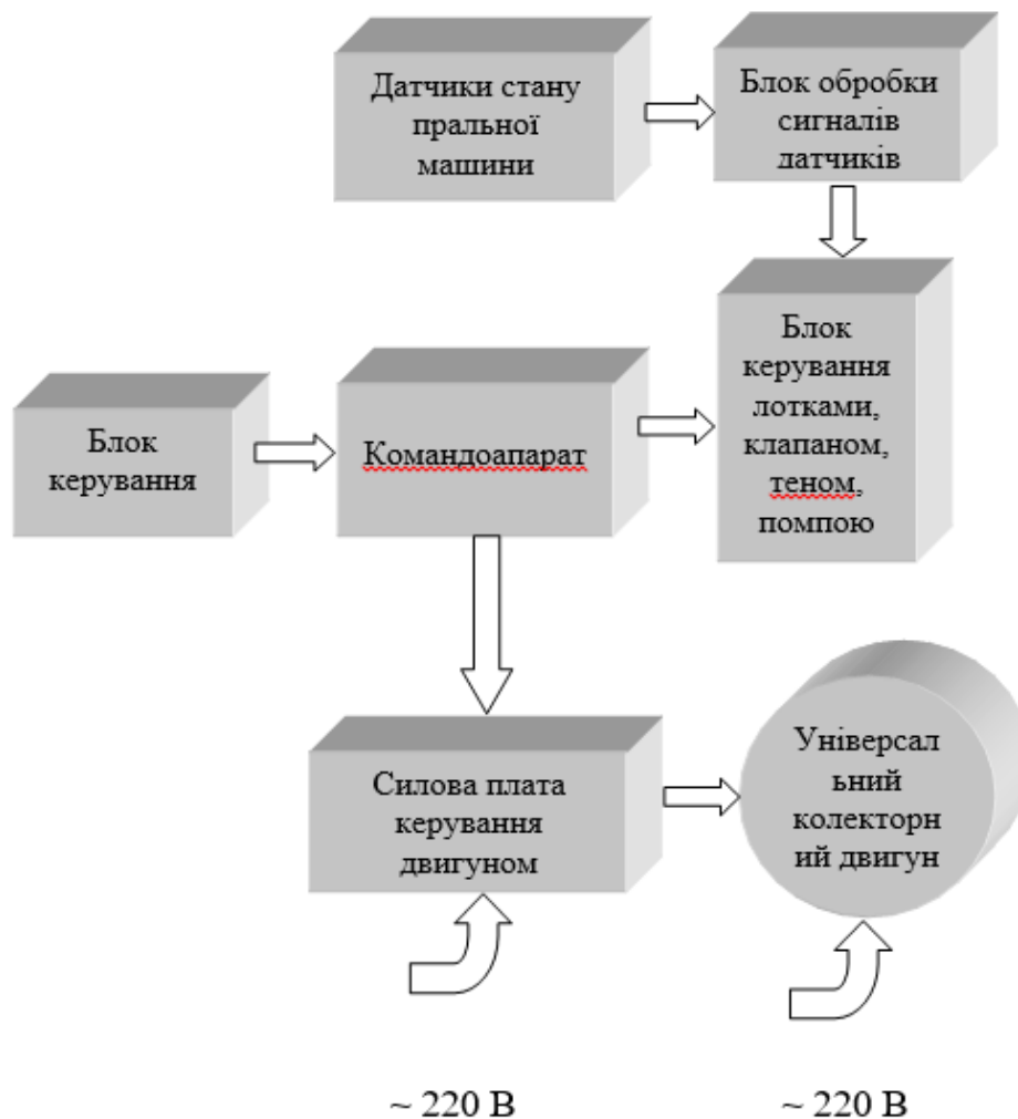
Рисунок 2.1 – Схема управління пральною машиною з використанням командоапарата
