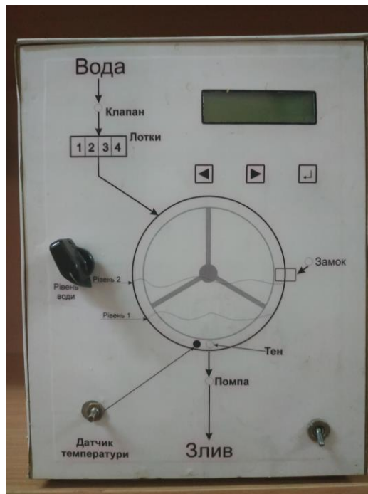
Рисунок 2.12 – Фото пристрою, що імітує роботу пральної машини
