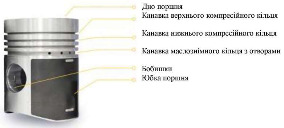
Рис. 1 Конструкція поршня
