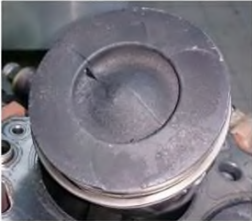
Тріщина та сліди ударів на днищі поршня
