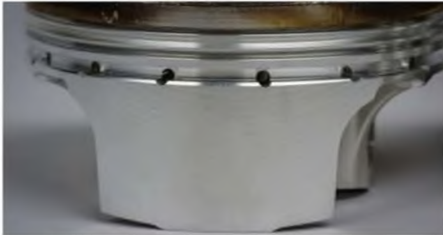
Ущільнююча частина поршня з отворами
