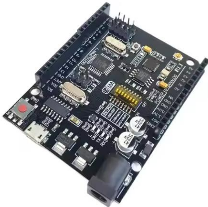
Рисунок 2.2 – Плата розробника Arduino Uno WiFi R3 [10]
