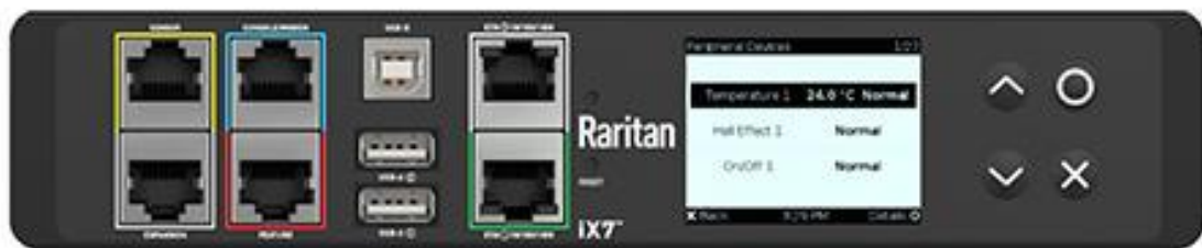
Рисунок 1.10 – Пристрій для моніторингу мікроклімату в серверній шафі Raritan Smart Rack Controller [13]
