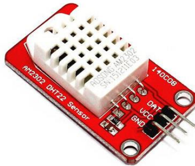
Рисунок 2.4 – Датчик температури та відносної вологості DHT22 [3]
