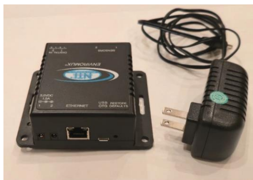
Рисунок 1.5 – Система моніторингу мікроклімату серверної шафи ENVIROMUX-MICRO-T [20]
