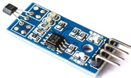
Рисунок 2.5 – Датчик Холла LM393 [4]
