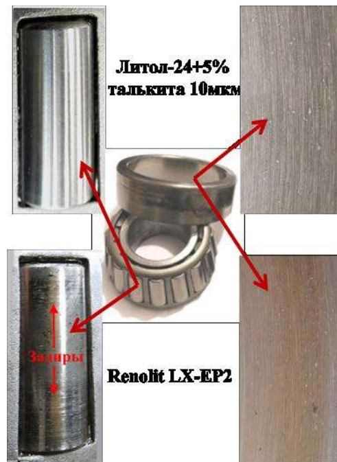
Рис. 4.11 Фотографії поверхонь кілець та роликів підшипників після року експлуатації.
