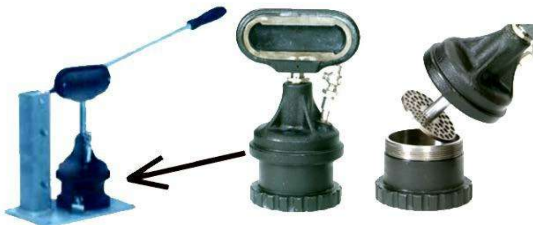
Рис. 2.2 Ручний перемішувач консистентних мастил (Воркер).
