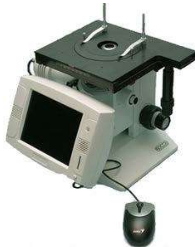
Рис. 2.7 Мікровізор металографічний інвертований \mu Vizo-Met-221 \mu Vizo-
