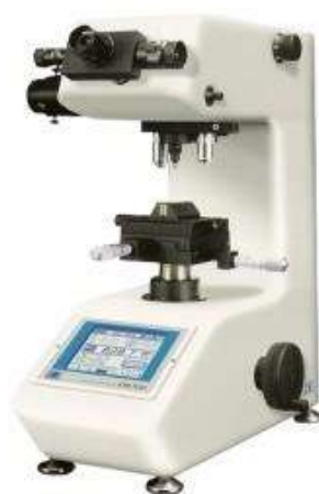
Рис. 2.6 Автоматичний мікротвердомір Future Tech FM-300
