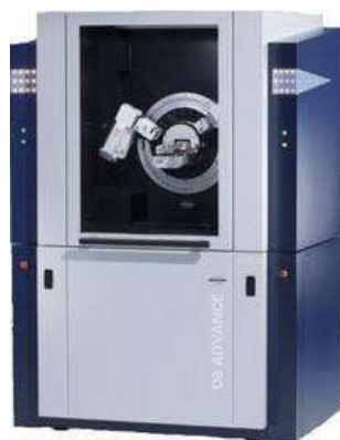
Рис. 2.9 Рентгенівський дифрактометр Bruker D8 Advance
