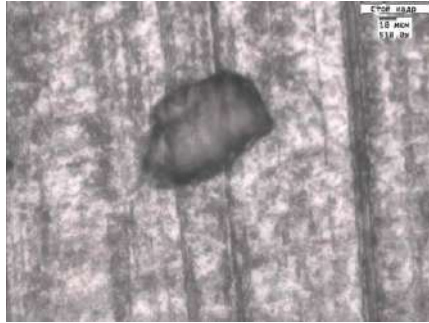
Рис. 4.2. Склоподібне тіло, виявлене на поверхні тертя роликового підшипника
