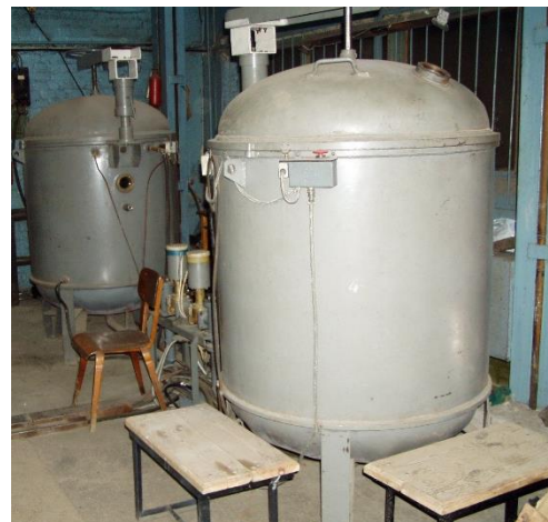
Рисунок 3.4. Загальний вид установки азотування в тліючому розряді УАТР-50 (варіант двокамерної установки)
