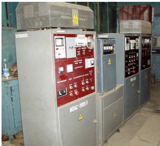
Рисунок 3.4. Загальний вид установки азотування в тліючому розряді УАТР-50 (варіант двокамерної установки)
