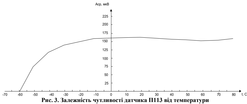
Рис. 3. Залежність чутливості датчика П113 від температури
