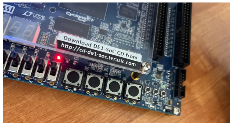
Рисунок 3.2 - Блок апаратних перемикачів та тактових кнопок для керування логікою ядра
