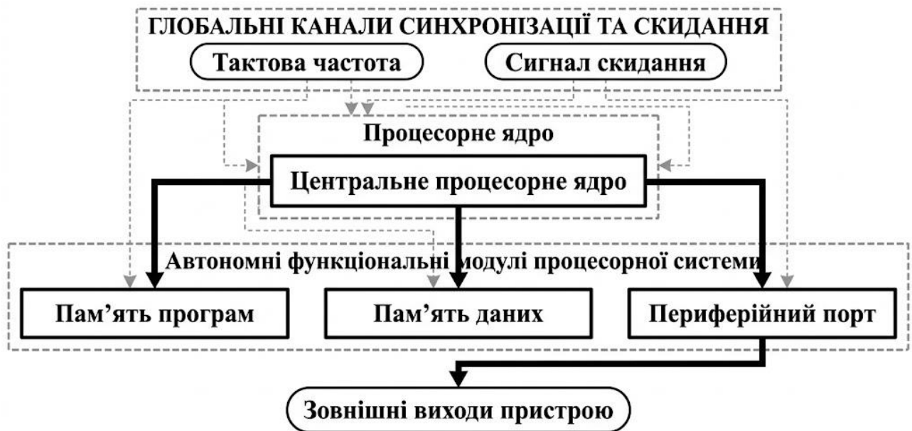
Рисунок 1.5 - Схема взаємодії пристрою керування та операційних модулів процесорного ядра
