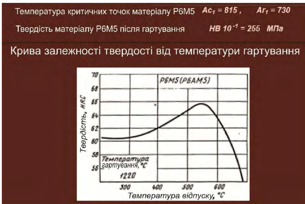
Рисунок 1.12 – Термічна обробка сталі Р6М5
