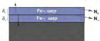
Рис. 8 – Структура росту азотованого шару, сформована на інструментальній сталі
