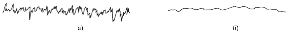
Рис.3 – Профиллограммы поверхности трения аморфно-кристаллических покрытий в условиях граничной смазки маслом МС-20 (P=15 ПМа): а – R_a=0,34 мкм ( V=0,8 м/с); б – R_a=0,16 мкм ( V=1,5 м/с); (ВУх1000, ГУх40).
