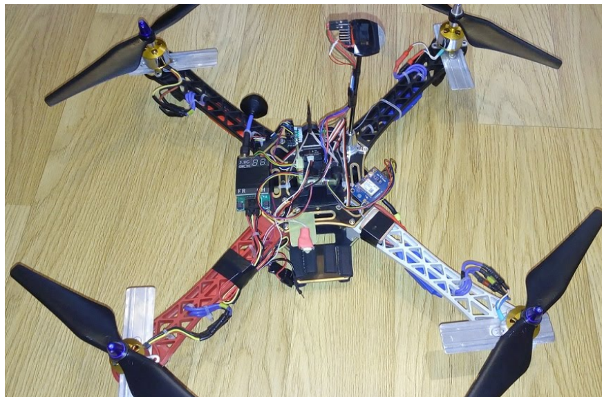
Рис. 12. Фото квадрокоптера на контроллере cc3d
