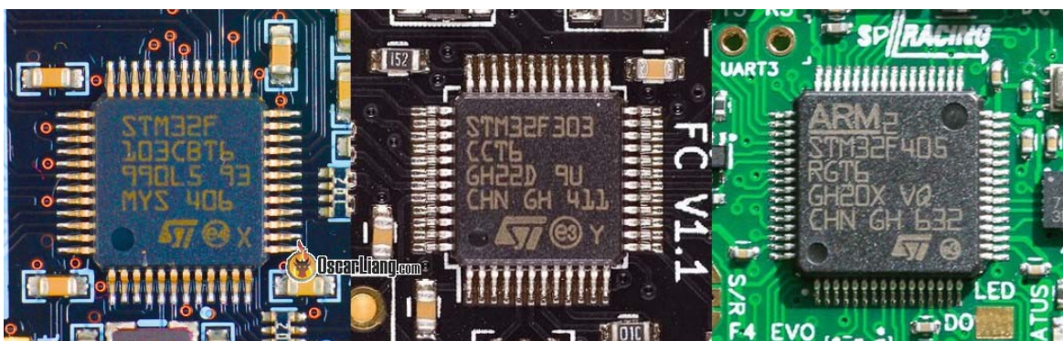
Рис. 1. STM32 F1, F3, F4 в полетных контроллерах
