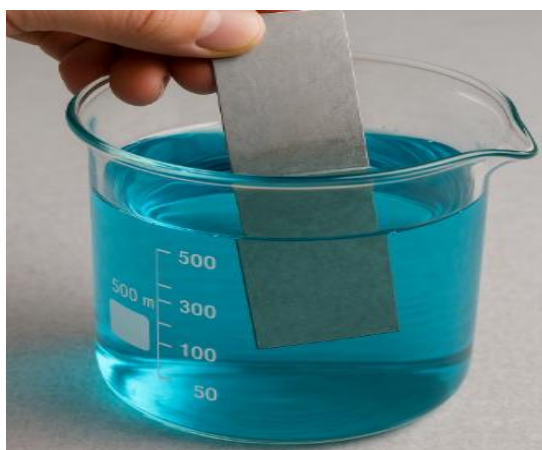
Рисунок 2.1-Хімічна обробка металу з утворенням пасивного шару.
