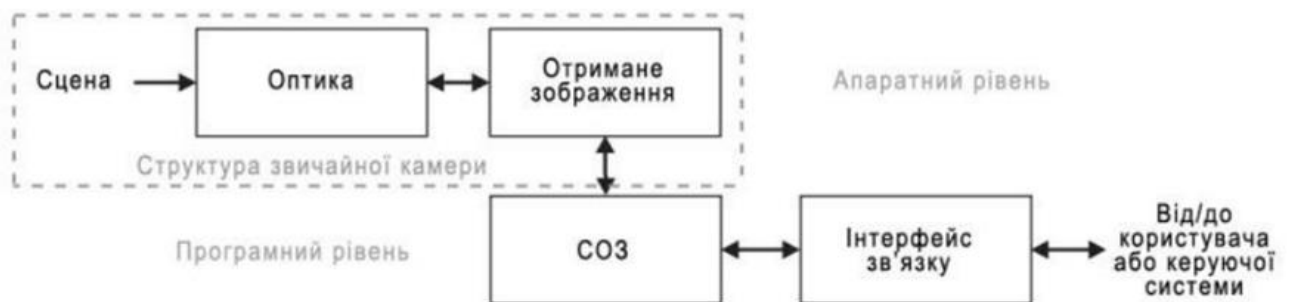
Рисунок 2.2 – Типова структурна схема побудови розумних камер [11]
