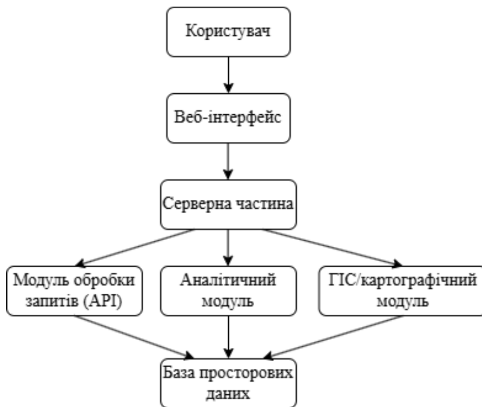
Рисунок 2.1 – Загальна архітектура інформаційної системи аналізу просторових даних
