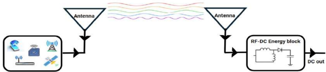
Рисунок 1.2 – Схема системи радіочастотного збору навколишнього середовища
