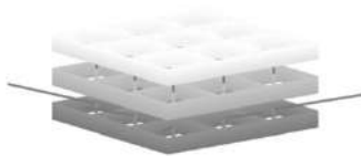
Рис. 3. Вертикальна структура підматриць з блоком формування напрямленості та фазовим керуванням
