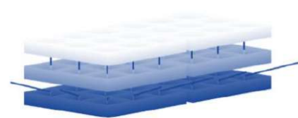
Рис. 4. Взаємозв'язок двох підматриць 3 \times 3 через комбінатори потужності
