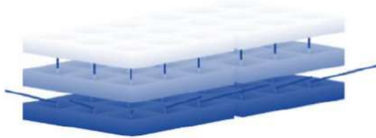
Рисунок 3.4. Взаємозв'язок двох підматриць 3 \times 3 через комбінатори потужності
