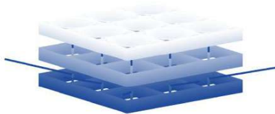
Рис. 3. Вертикальна структура підматриці з блоком формування напрямленості та фазовим керуванням
