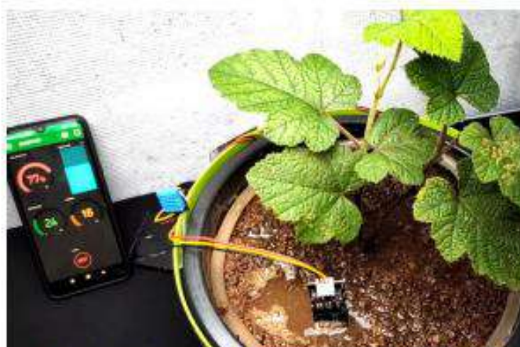
Рисунок 3 – Кіберфізична система моніторингу стану рослин в режимі реального часу
