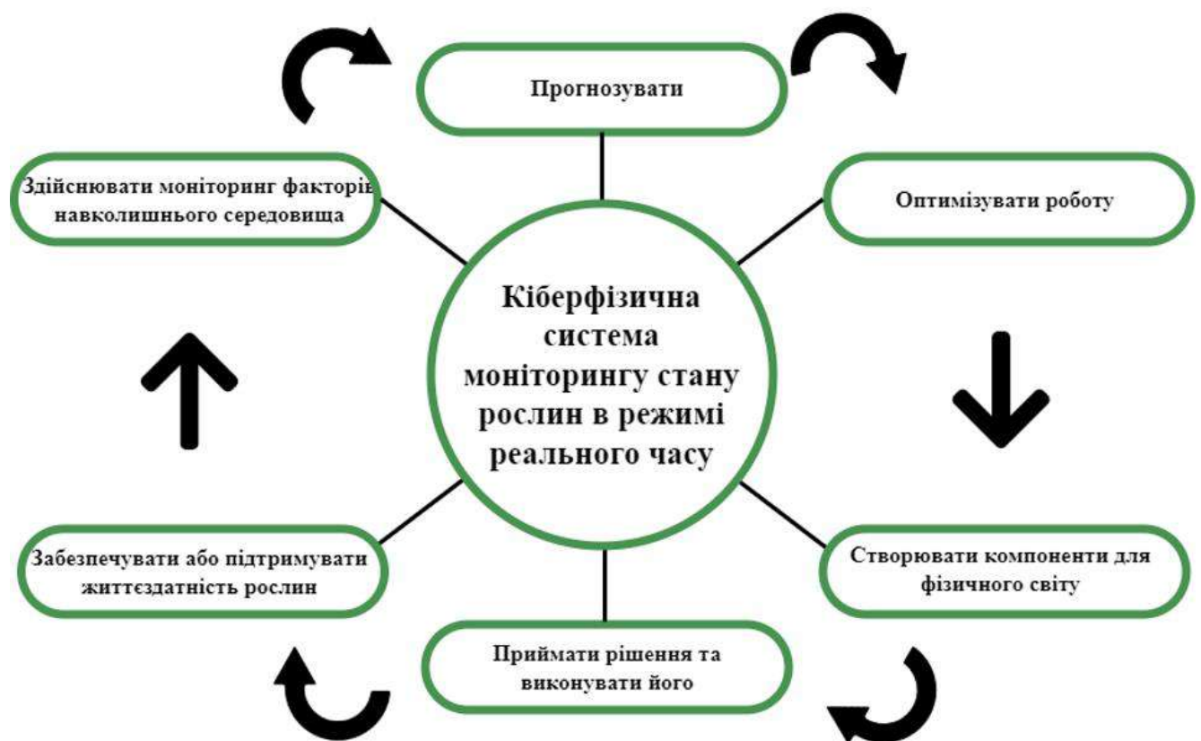
Рисунок 2.3 – Класифікація призначень кіберфізичної системи моніторингу стану рослин в режимі реального часу
