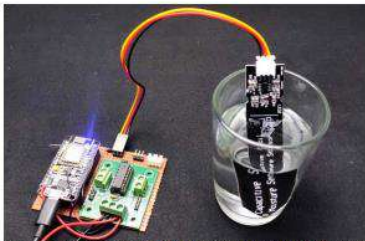
Рисунок 2 – Апаратна частина кіберфізичної системи моніторингу стану рослин в режимі реального часу
