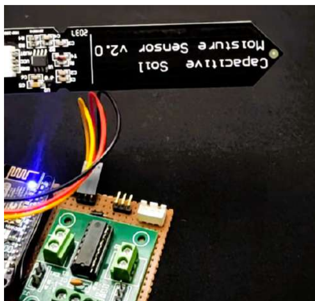
Рисунок 4.4 – Підключення ємнісного датчика вологості ґрунту, що вимірює рівень води у субстраті
