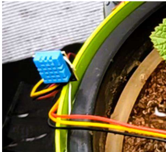
Рисунок 4.5 – Встановлення датчика DHT11 на горщик
