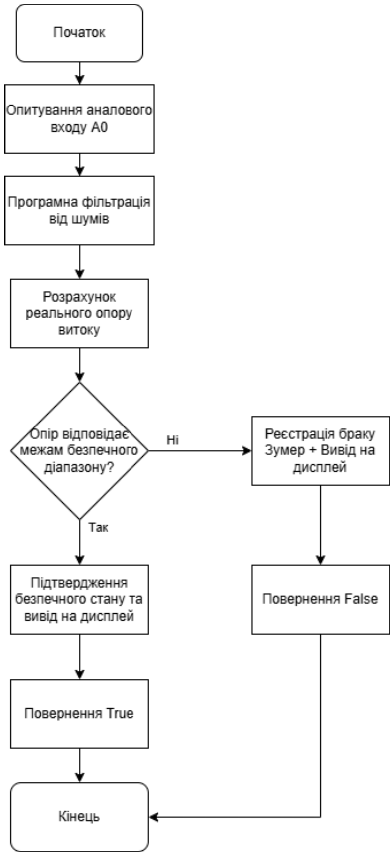
Рисунок 3.12 – Блок-схема обробки даних ESD-тестування мікроконтролером
