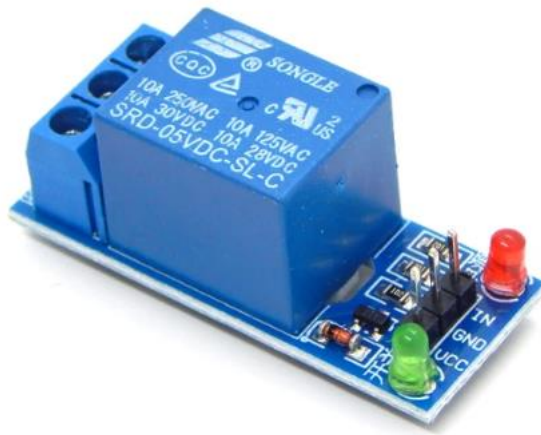
Рисунок 2.6 – Зовнішній вигляд модуля силового реле з опторозв'язкою
