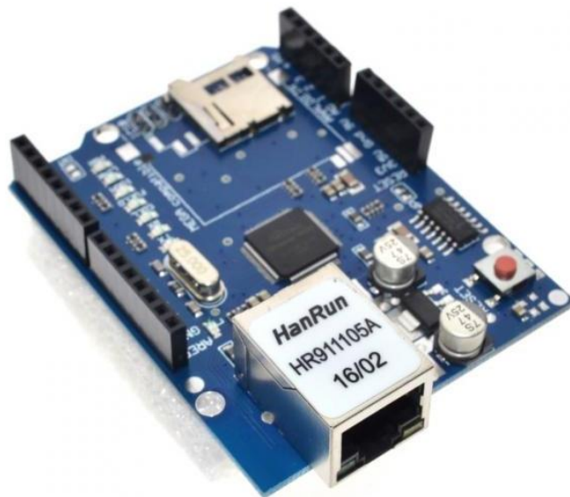
Рисунок 2.15 – Зовнішній вигляд мережевого модуля WizNet W5100 (Ethernet Shield)
