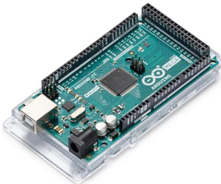
Рисунок 2.2 – Зовнішній вигляд мікроконтролерної платформи Arduino Mega 2560
