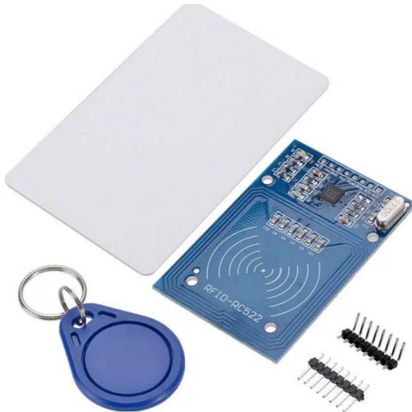
Рисунок 2.3 – Зовнішній вигляд RFID-модуля RC522
