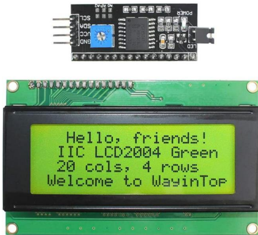
Рисунок 2.5 – Зовнішній вигляд символьного дисплея LCD 2004 з I2C-адаптером
