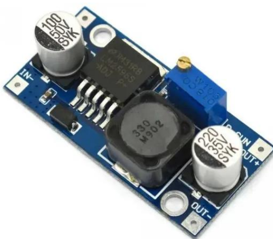
Рисунок 2.11 – Імпульсний понижуючий DC-DC перетворювач LM2596S
