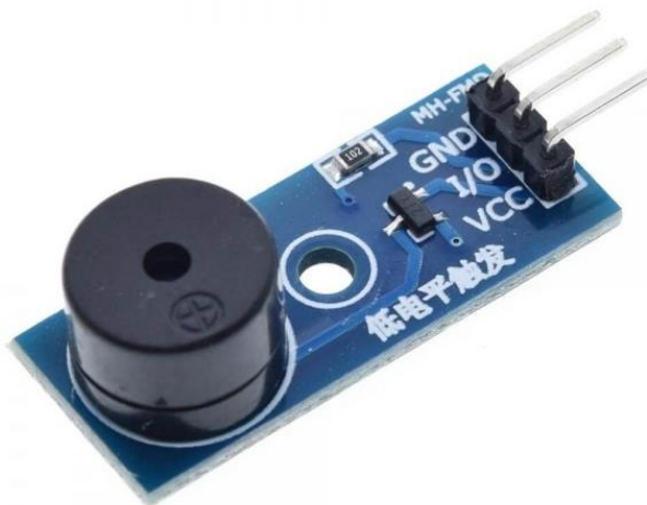
Рисунок 2.7 – Зовнішній вигляд активного п'єзовипромінювача
