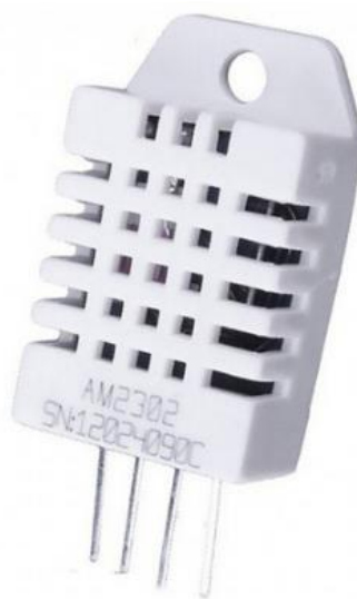
Рисунок 2.4 – Зовнішній вигляд цифрового датчика мікроклімату DHT22
