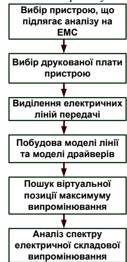
Рис 2. Порядок дослідження плат на EMC
