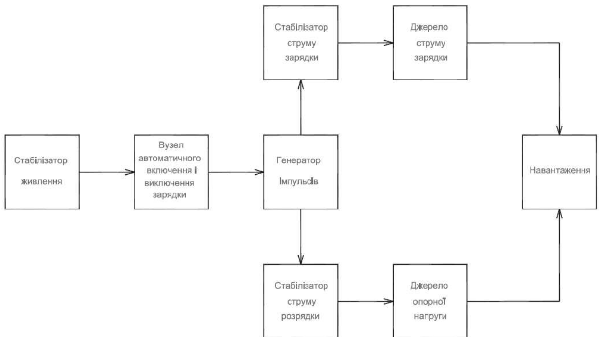
Рисунок 2.1 – Схема структурна тренувального пристрою акумуляторної батареї
