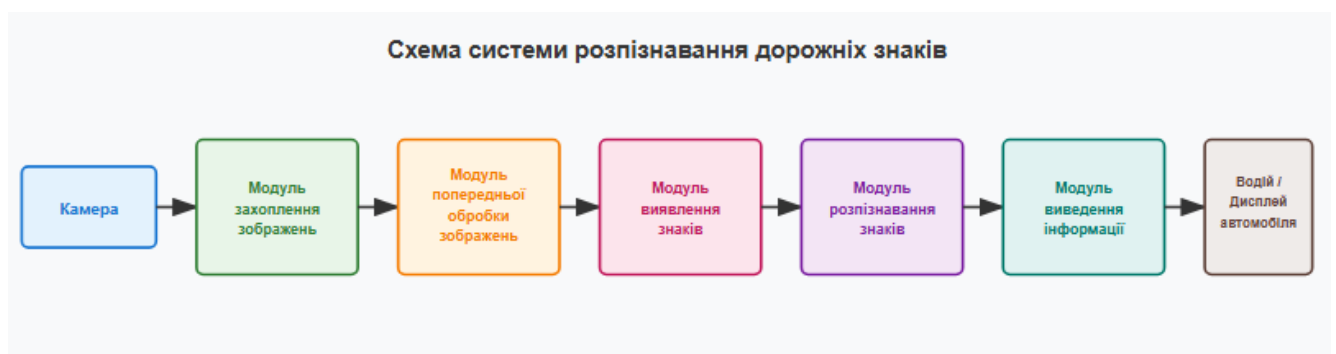
Рисунок 2.1 – Структурна схема системи виявлення та розпізнавання дорожніх знаків [36]
