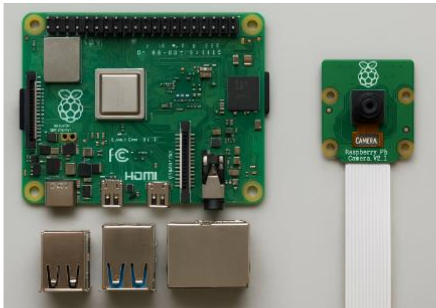
Рисунок 3.2 – Основні апаратні компоненти системи: одноплатний комп'ютер Raspberry Pi 4 Model B (ліворуч) та камера Raspberry Pi Camera Module v2.1 (праворуч).
