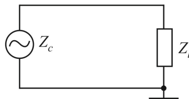
Рисунок 1.4 – Схема з'єднання кабеля зв'язку з навантаженням
