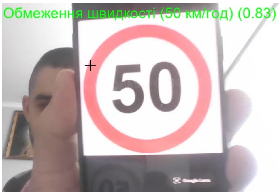
Рисунок 3.4 – Розпізнавання знаку Обмеження швидкості (50 км/год)
