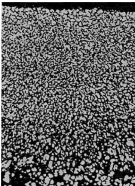
Рисунок 1.4. Мікроструктура дифузійного шару сталі 30X3Г2Ф x 200 (цементация при 900°C, 8 годин), вміст карбідної фази більше 80%.
