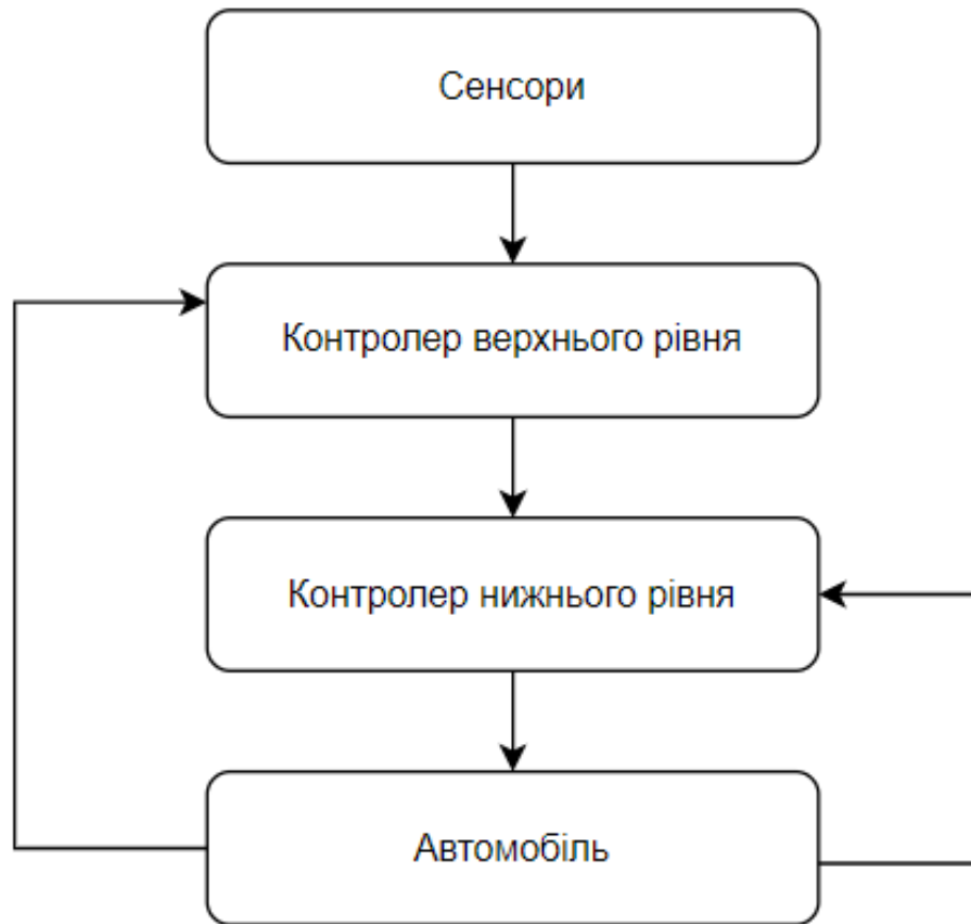
Рисунок 2.1 – Схема взаємодії складових системи адаптивного круїз контролю
