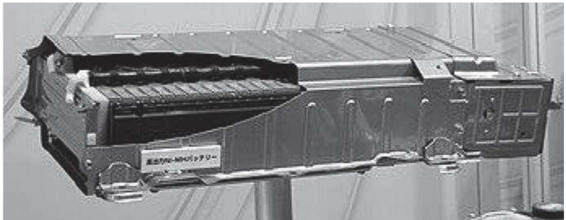
Рисунок 1.18 - Нікель-метал-гідридний акумулятор (NiMH) у розрізі
