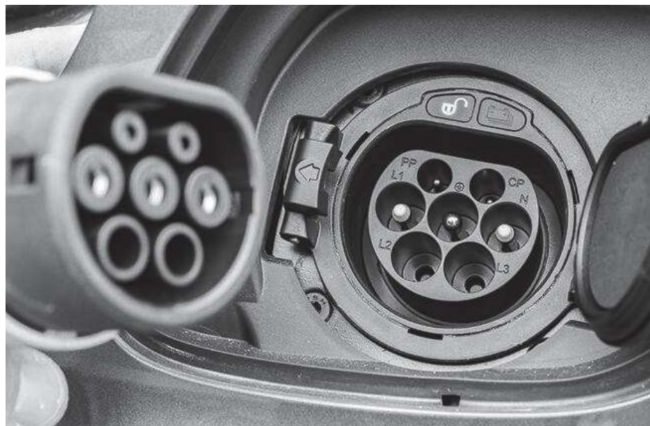
Рисунок 1.6 - Зарядний порт та бортовий зарядний пристрій (ЗП).
