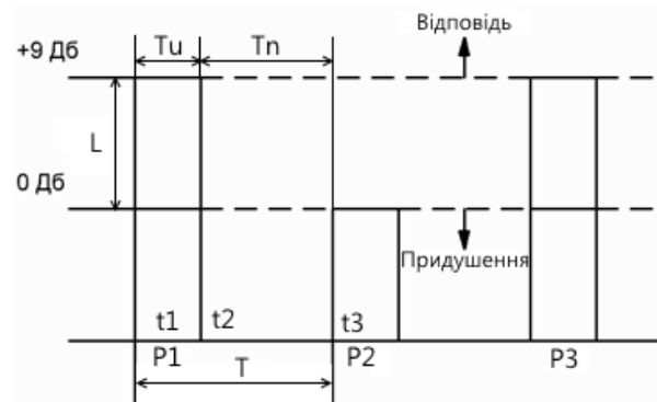
Рис. 1. Принцип передачі триімпульсного сигналу
