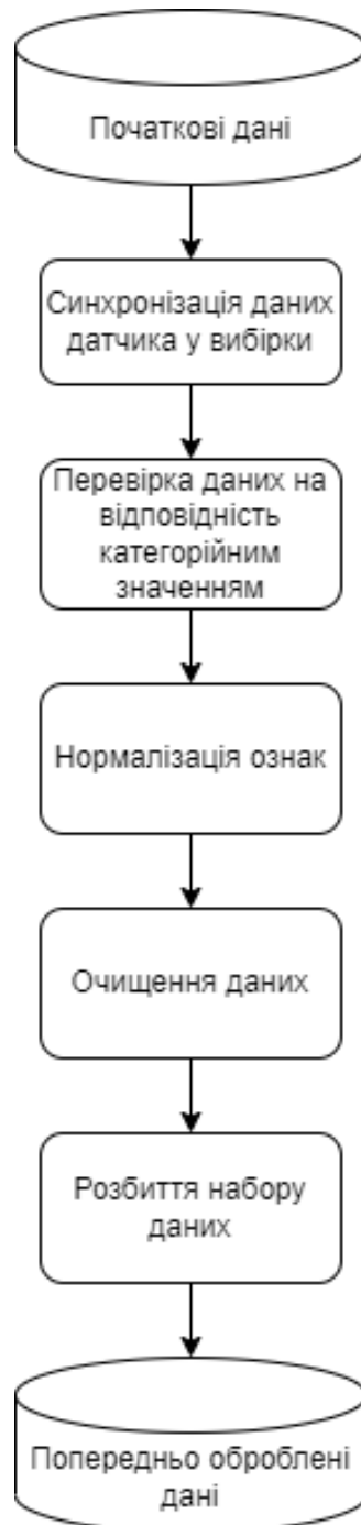
Рисунок 2.4 – Алгоритм попередньої обробки даних перед подачею в алгоритм машинного навчання
