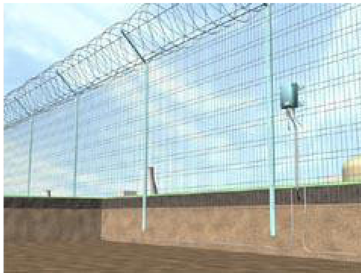
Рисунок 1.6 – Встановлення чутливого елемента для виявлення підкопу
