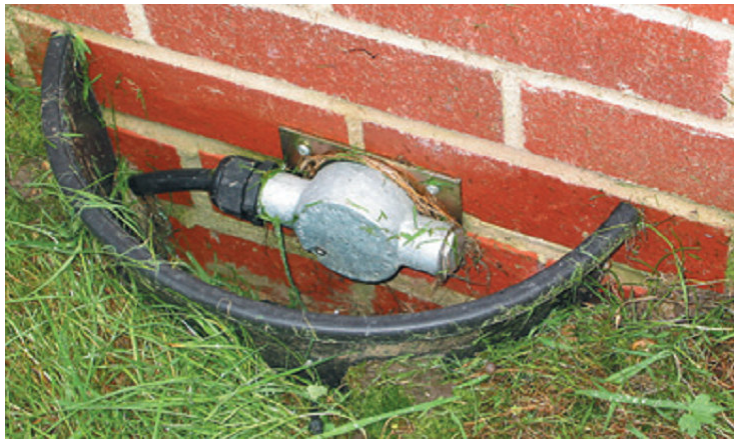
Рисунок 1.9 – Підземний геофонний давач системи Psicon, що закріплено на стіні для контролю подолання паркану
