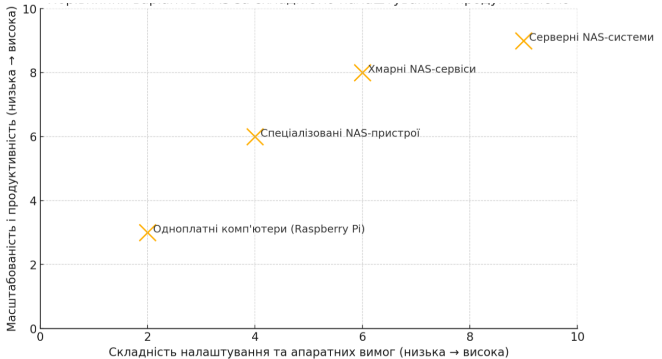
Рисунок 2.1 – Співвідношення між складністю налаштування та апаратних вимог і масштабованістю з продуктивністю для різних типів NAS.
