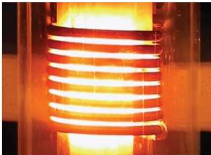
Рисунок 3.3 – Індукційний спосіб нагріву
