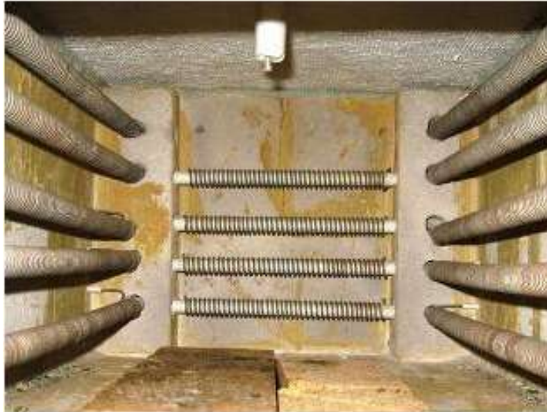
Рисунок 3.1 – Вигляд контактного способу нагріву
