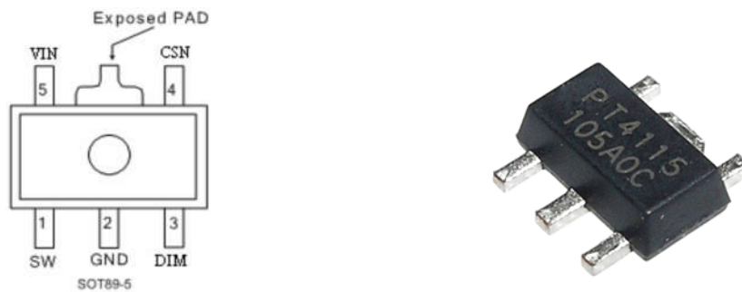
Рисунок 3.19 – Зовнішній вигляд та призначення виводів LED драйвера PT4115
