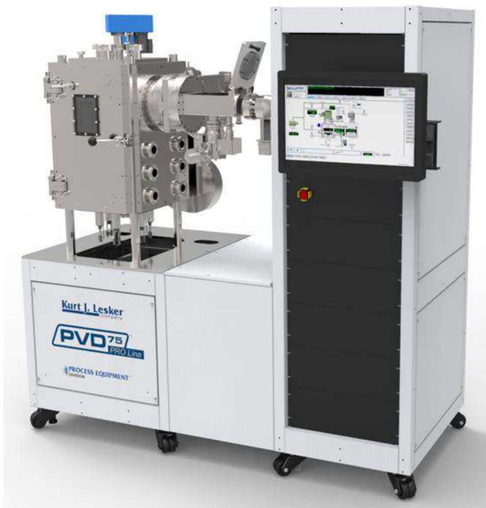
Рисунок 2.1 – Установка магнетронного розпилення типу Kurt J. Lesker PVD 75
