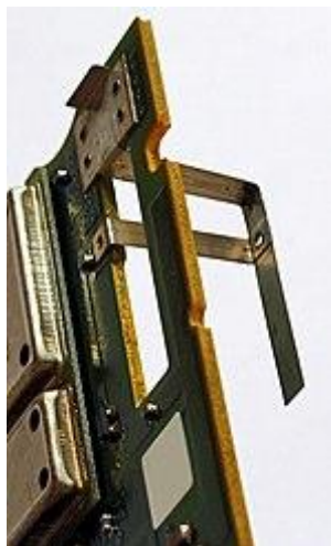
Рисунок 2.1 – Інвертована F-антена в базовій станції DECT (технологія, яка використовується для бездротових телефонів і подібних пристроїв)
