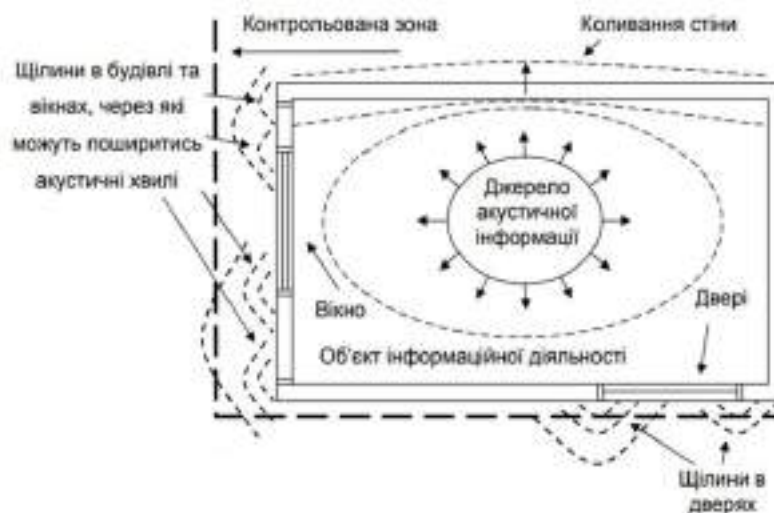
Рисунок 1.2 – Акустичні канали витоку інформації [29]
