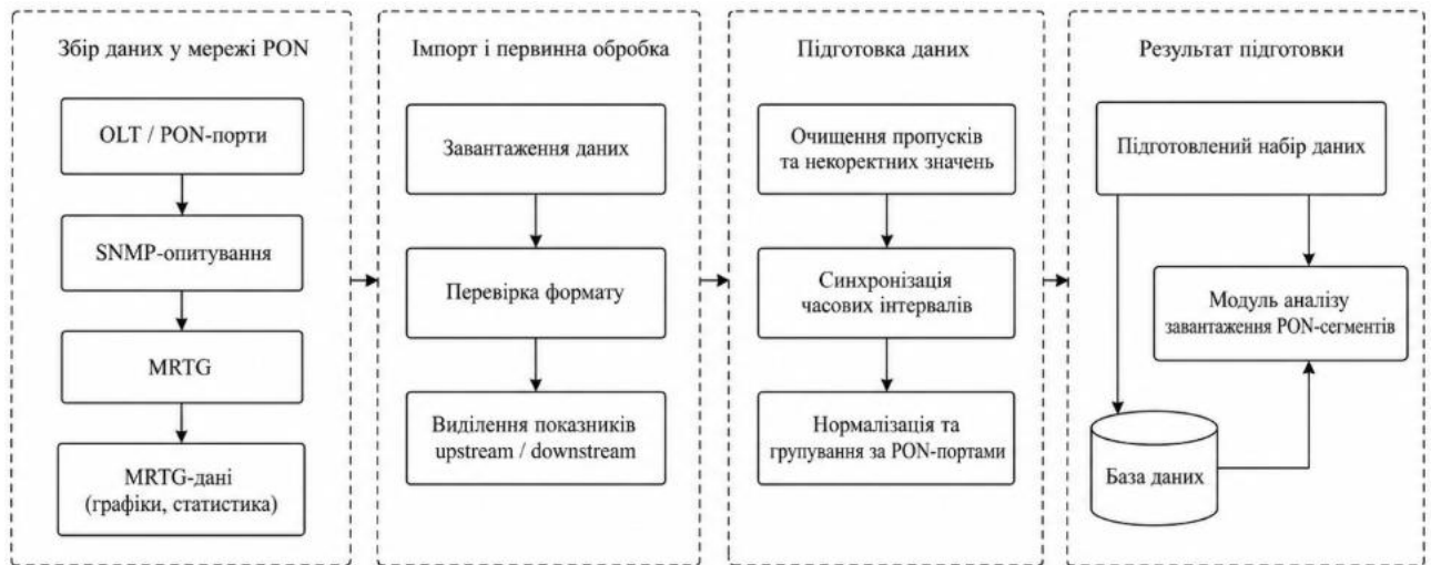
Рисунок 2.2 – Модель збору та підготовки MRTG-даних для аналізу завантаження PON-сегментів
