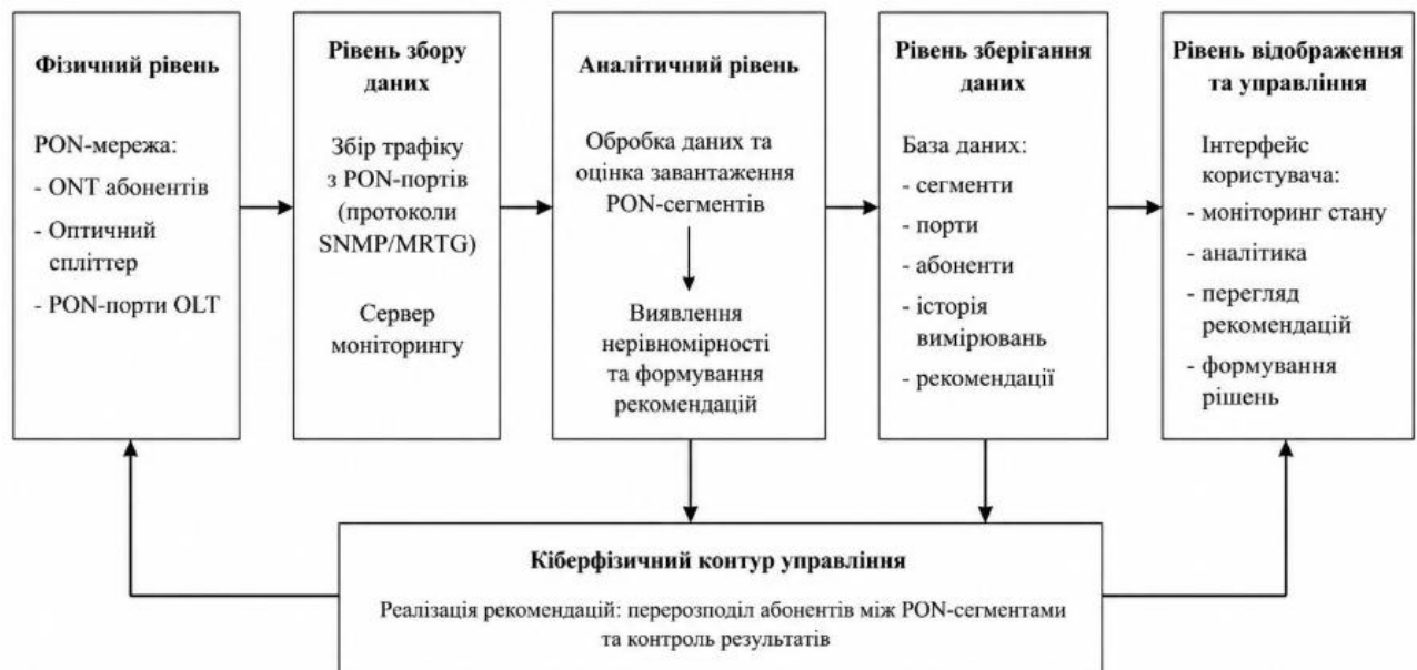
Рисунок 2.1 – Загальна архітектура кіберфізичної системи розподілу абонентів у мережі PON
