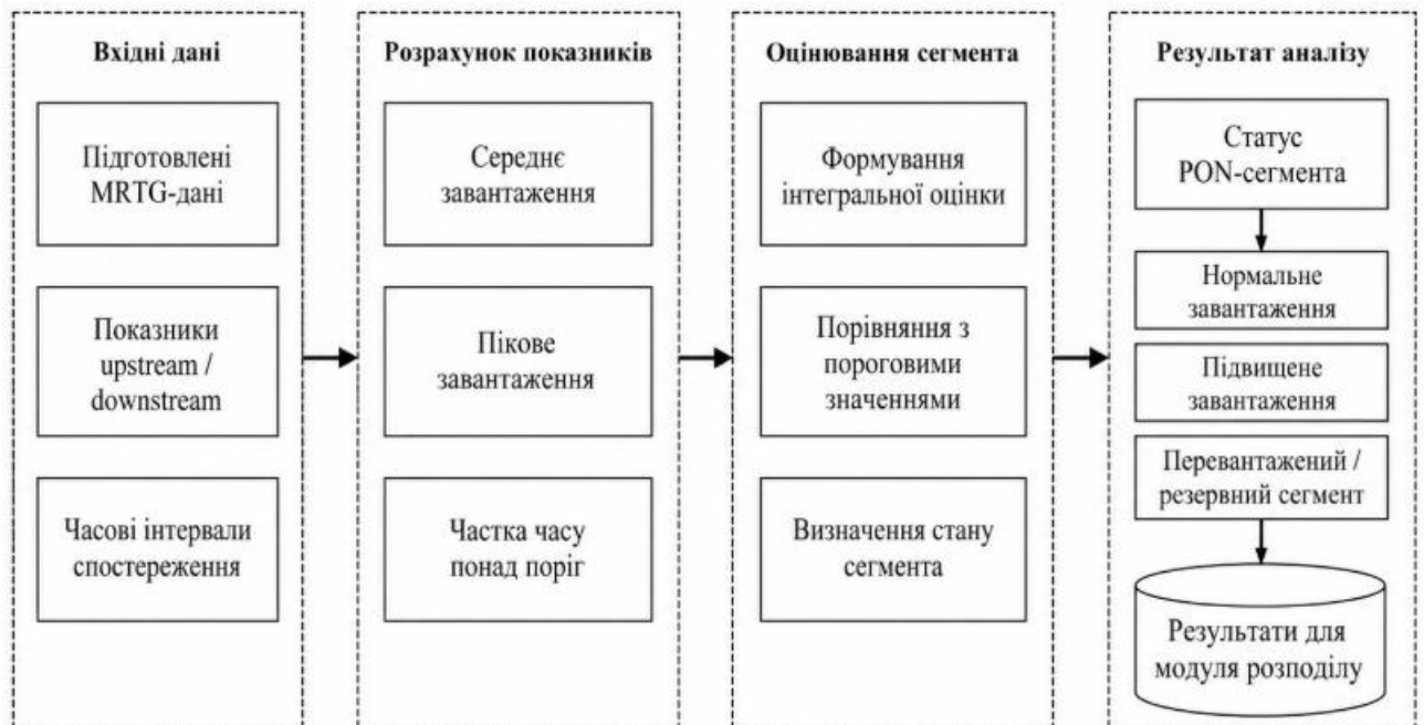
Рисунок 2.3 – Метод визначення завантаженості PON-сегментів на основі MRTG-даних
