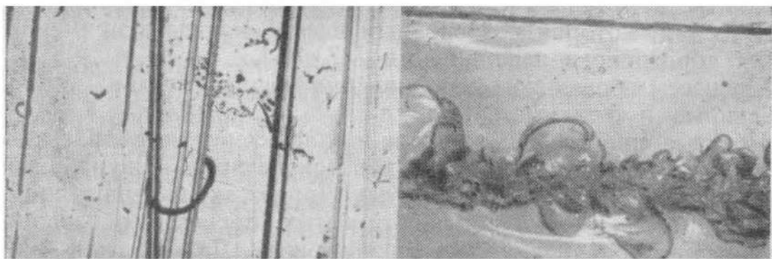
Рис. 1.5. Сліди в'язкого руйнування, виниклі на поверхневому шарі сталюого зразка (а), та сліди крихкого руйнування, що виникли на поверхневому шарі скла при ушкодженні абразивною частинкою .
