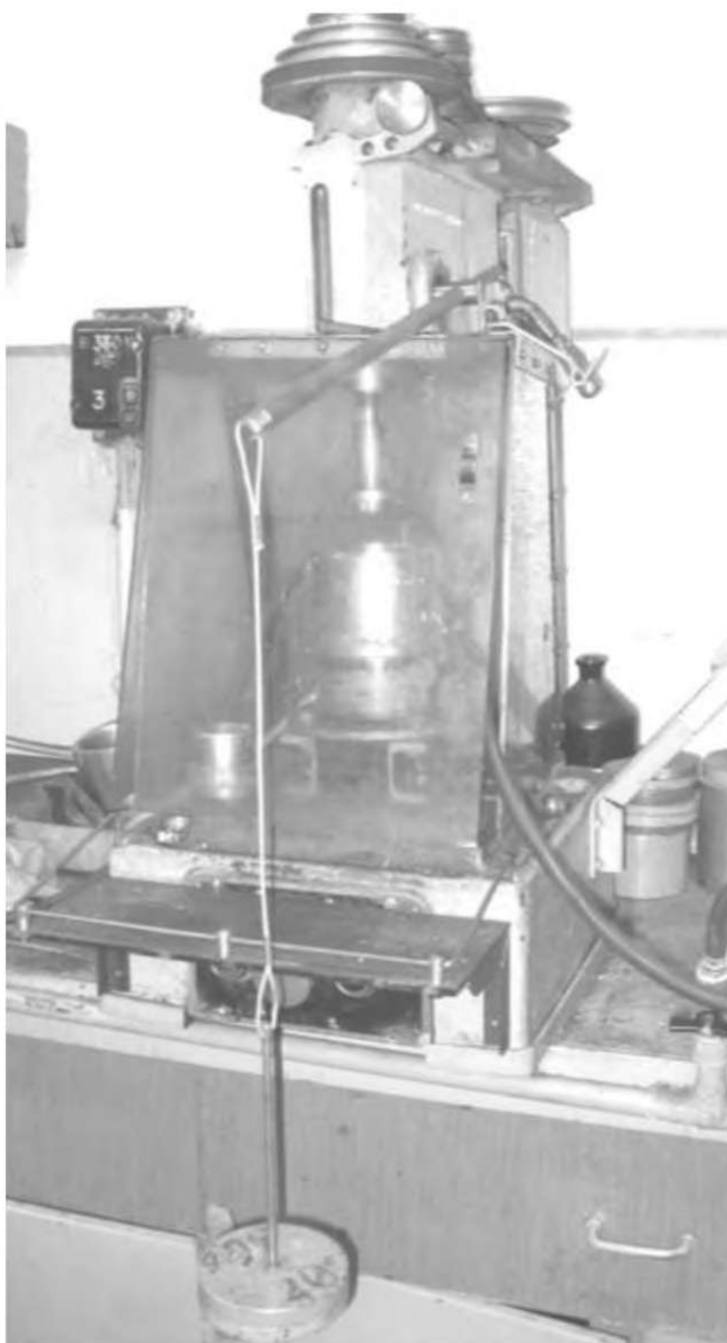
Рис. 2.1. Загальний огляд експериментальної системи для проведення тестів на зношування
