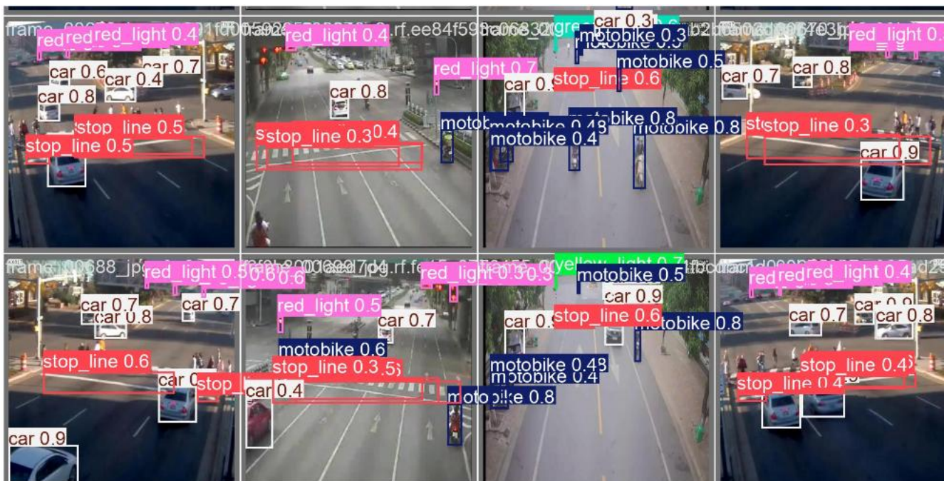
Рисунок 4.11 – Результати роботи навченої нейронної мережі на предмет розпізнавання дорожньої обстановки
