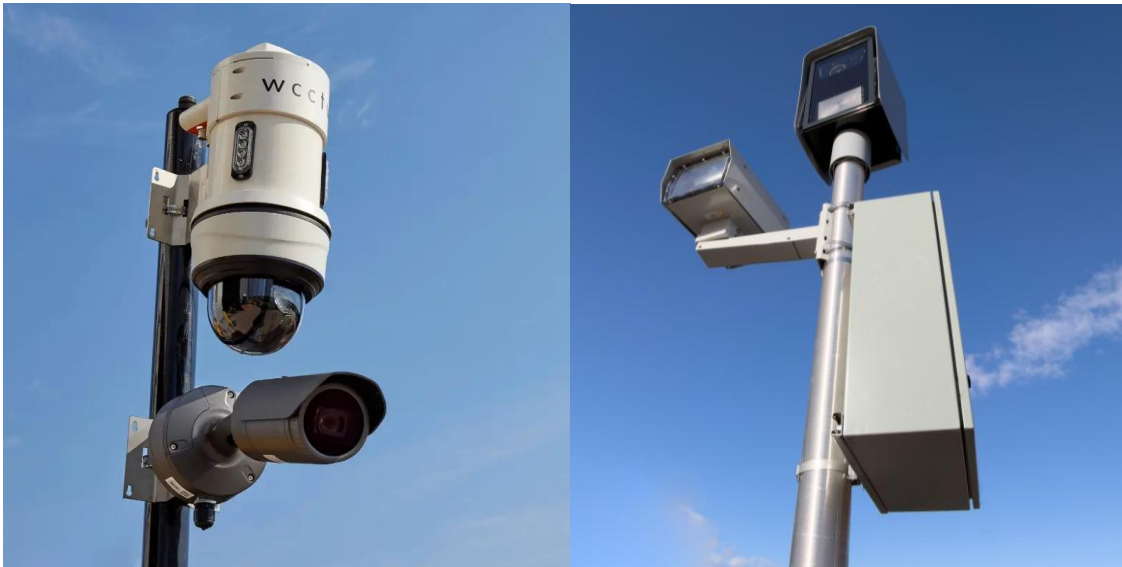
Рисунок 2.3 – Приклад камер спостереження для розробки кіберфізичної системи автоматичної фіксації порушень правил дорожнього руху [63]
