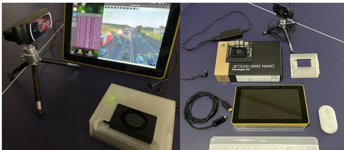
Рисунок 1.9 – Приклад Edge-AI архітектури з використанням NVIDIA TAO + Jetson Orin Nano для моніторингу дорожнього руху у розумних містах згідно [20]
