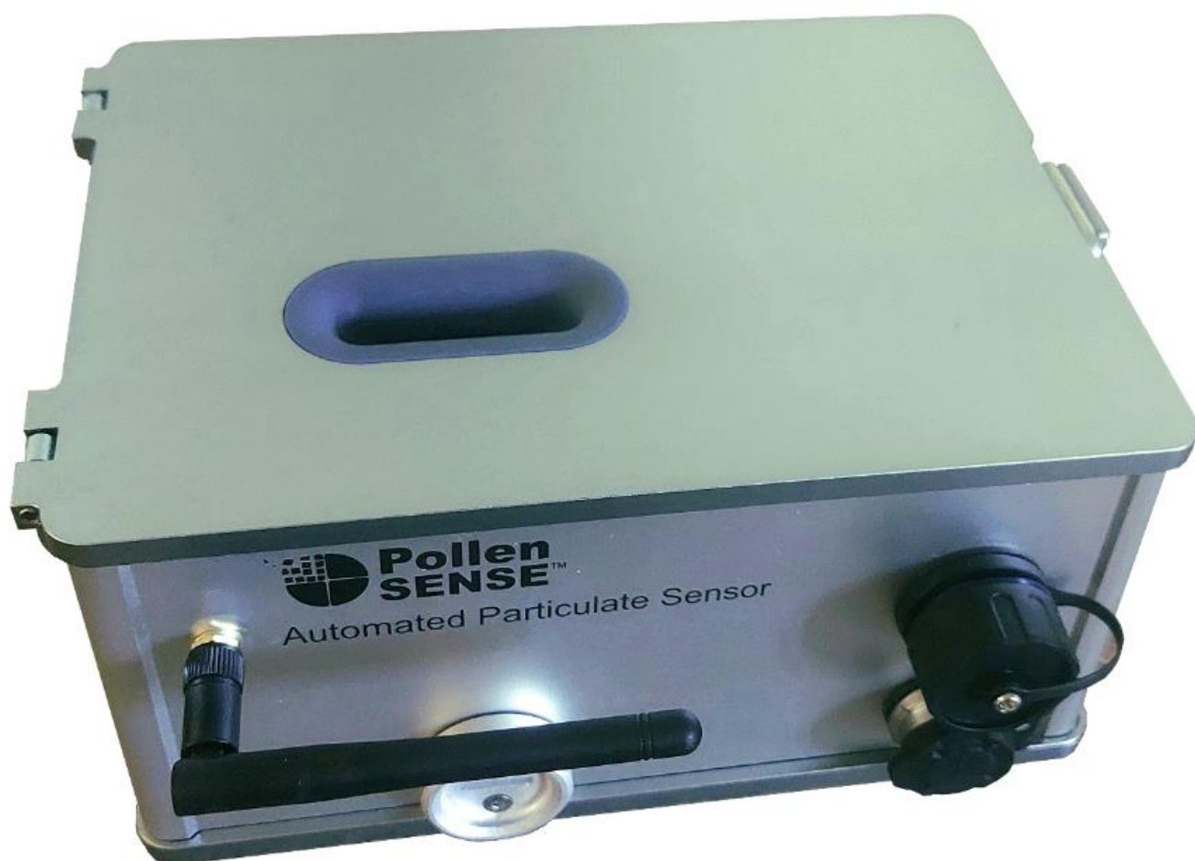
Рисунок 2.5 – Датчик пилку Pollen Sense APS-400 [93]
