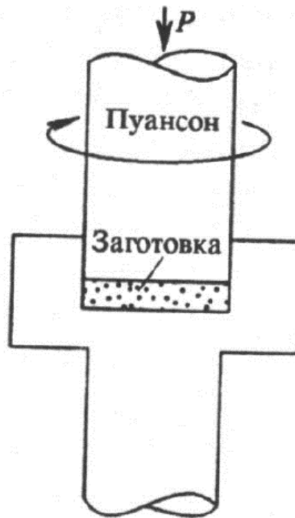
Рисунок 1.12 – Схема методу крутіння під високим тиском
