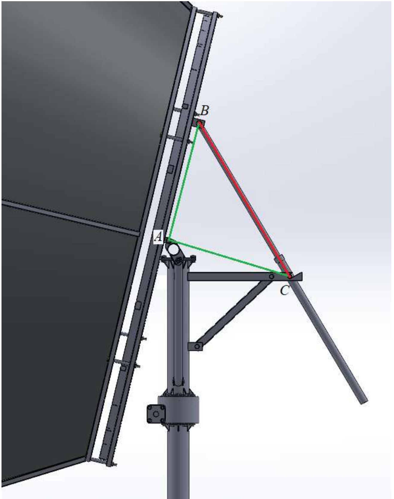
Рисунок 2.20 – 3D модель трекерної системи при максимальному нахилі панелі
