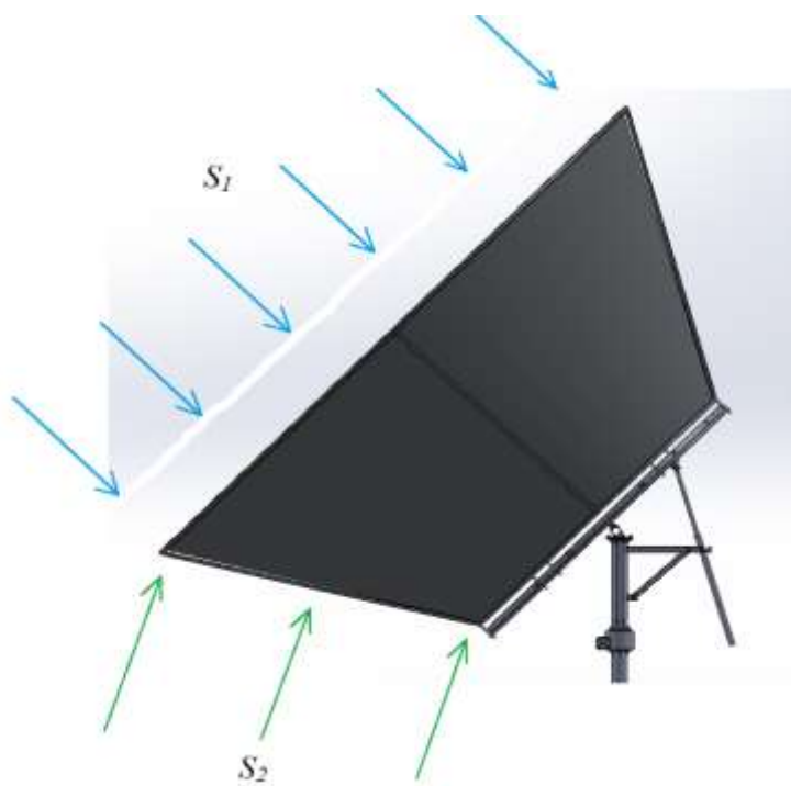
Рисунок 3.1 Напрями вітру при яких конструкція знаходиться під найбільшим навантаженням
