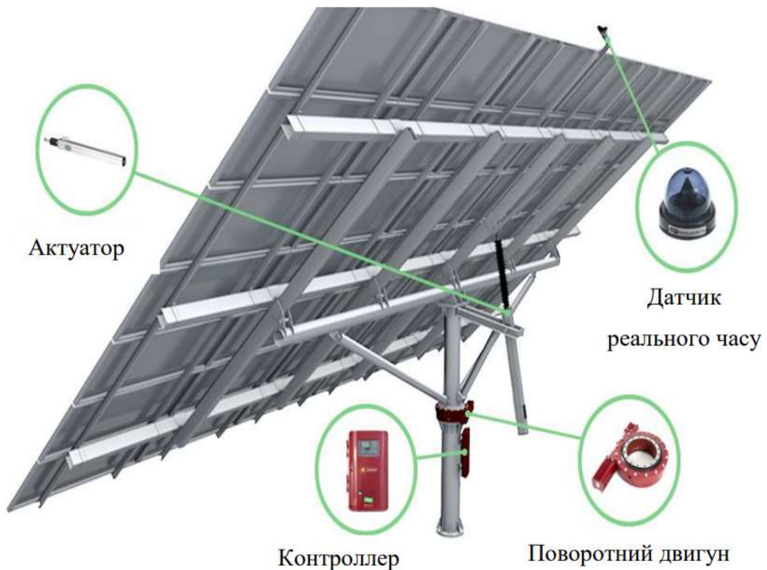
Рисунок 2.13 – Загальні складові конструкції сонячного трекера
