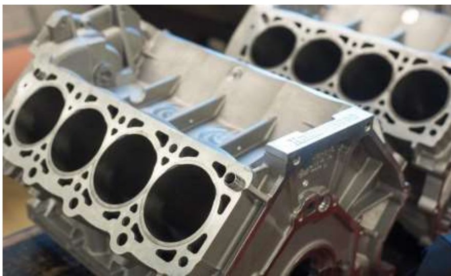
Рис. 1.1 Блок циліндрів виготовлений з алюмінієвого сплаву
