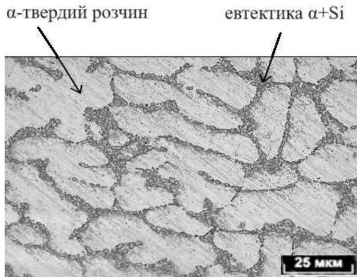
Рис. 3.1 Сплав АК7 після гартування з 540°C
