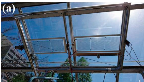
Рисунок 1.4 - Напівпрозорі фотоелектричні модулі, розташовані паралельно (А) або перпендикулярно (В) до поверхні даху [23]
