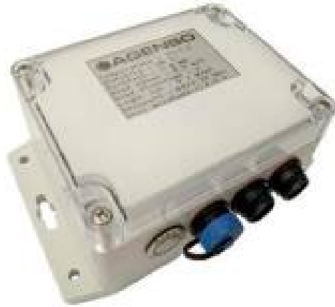
Рисунок 2.22 - Базова станція Agenso2.1.4 Обладнання бази ESP-32
