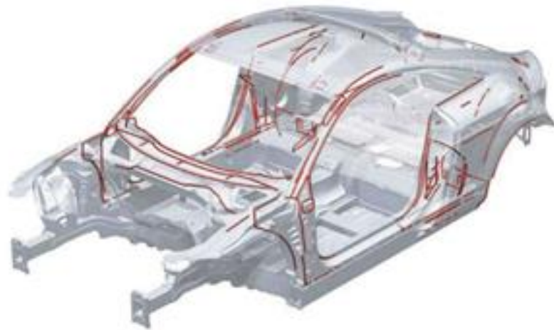
Рис 1.10. Точки застосування структурного склеювання
