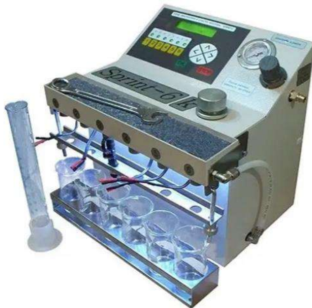
Рис. 2.3 – Стенд для діагностики і чистки форсунок Sprint6K, Україна [15]
