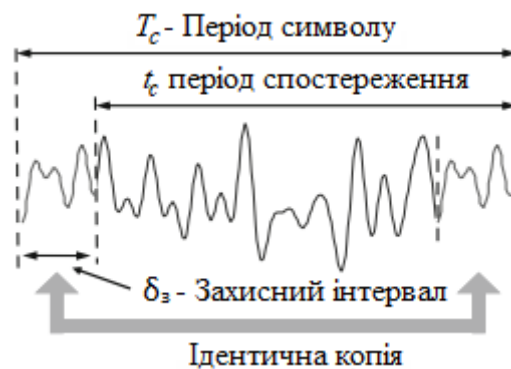
Рисунок 1.4 – Конструкція OFDM-сигналу (повна форма), один повний символ – часова форма
