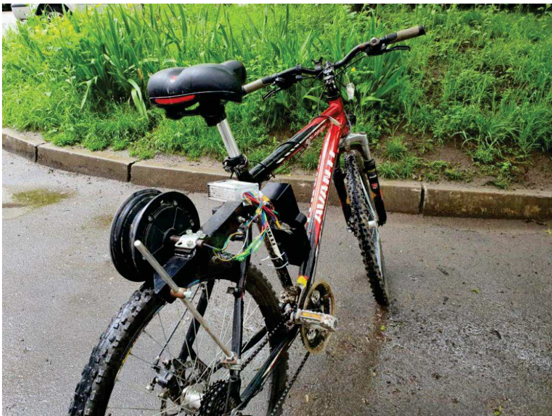
Рисунок 4.1 - реалізований електропривід велосипеда
